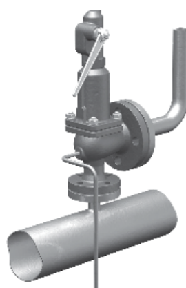
Правильная установка на паропровод
